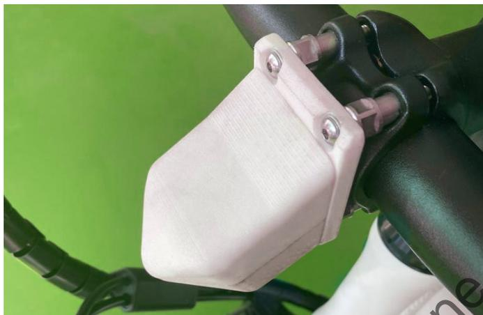
5. **Riconoscimento presenza nella ciclostazione tramite tag RFID.**
